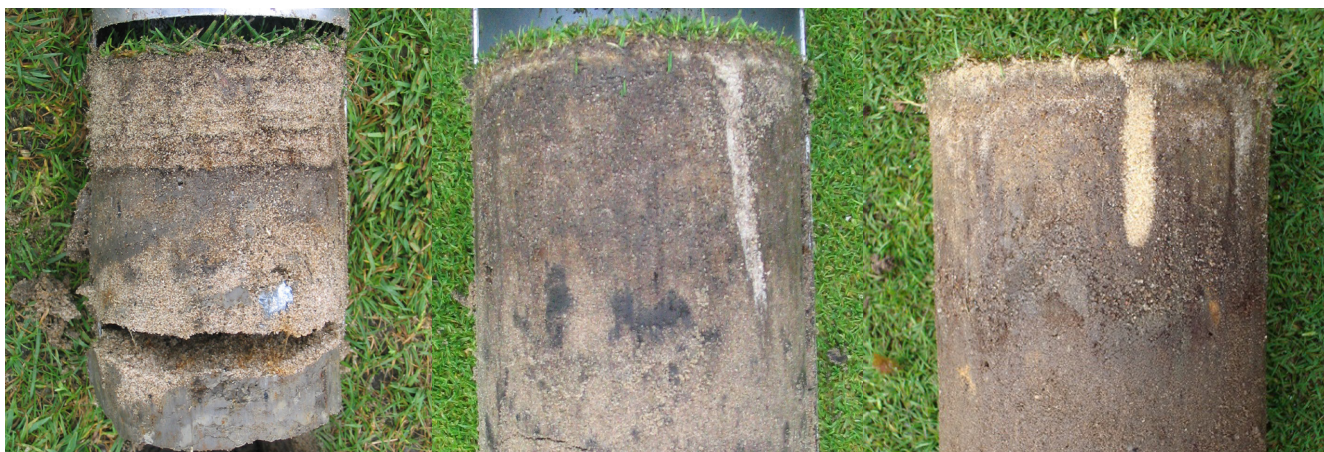
Foto 1 Maatregelen en uitvoeringsdiepte moeten worden afgestemd op specifieke situatie. Met zand gevulde sleuven of gaten werken alleen goed als het water vlot naar de ondergrond kan afvloeien.
